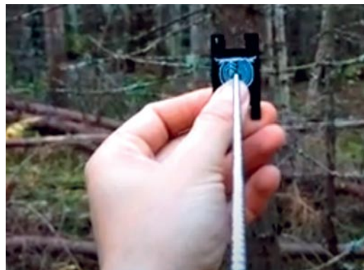
Ryc. 3. Pomiar płytką do prób kątowych
